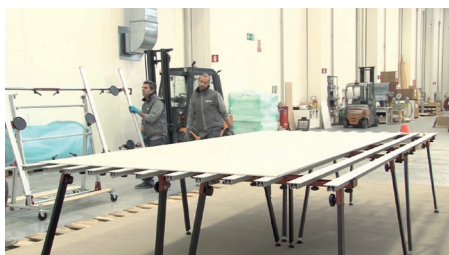
Banc doté de profilés en aluminium
